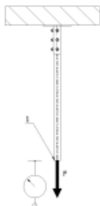
Figura 7b: Configurazione di prova della resistenza alla trazione / Test set-up for tensile strength
